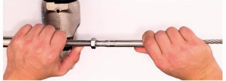
13. Продвигая наконечник, сделайте еще 4 обжима с интервалом 1 мм между ними. Также рекомендуется поворачивать наконечник после каждого обжатия, чтобы обжимы не были в одной плоскости, что может слегка изогнуть наконечник.
