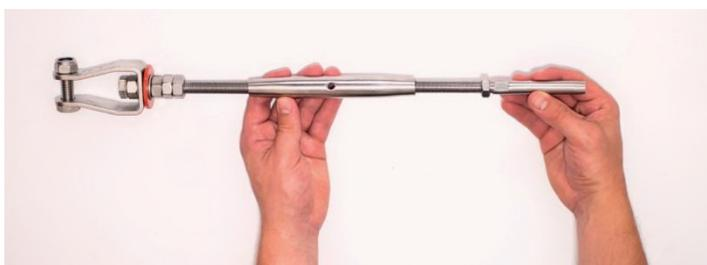
2. Свободно прикрепите натяжное устройство к начальному компоненту и, натягивая трос, сделайте на тросе отметку напротив спрессованного участка на натяжном устройстве. Теперь можно обрезать трос по отметке с помощью гидравлического резака Sembre HT-TC026. Это обеспечит правильное обрезание троса.
