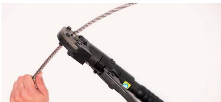
3. Поскольку трос обрезан на нужную длину, можно снять наконечник с начального компонента - он готов к обжатию.
