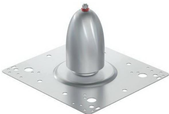
В центре плиты основания торговой марки Soter™ расположен купол, на вершине которого приварена приемная втулка M10, на которую надежно накручивается соответствующая опора. Место сварки полностью защищено от атмосферных воздействий. Плиты основания, предназначенные для использования на крышах с металлической кровлей, с обратной стороны оснащены опорами для плотного прикрепления к выступам кровли.
