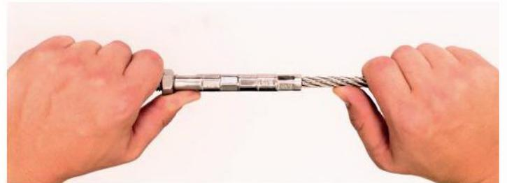
15. Наконечник теперь полностью обжат и может быть соединен с опорой путем извлечения болта и закрепления на опоре.
