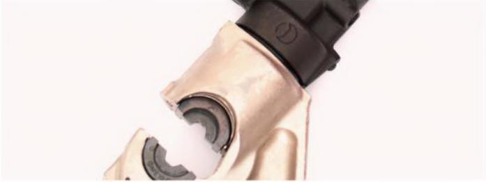
9 Расположите центральную часть по центру обжимной головки таким образом, чтобы первое обжатие было произведено рядом с отметкой на самом наконечнике.
