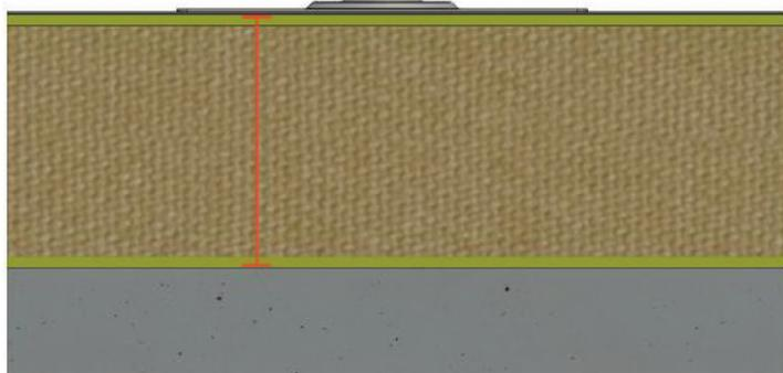
3 С помощью ударной дрели, удлинителя сверла и сверла ZVK-STOP просверлите отверстия в отмеченных местах сквозь кровлю в бетонное основание.
