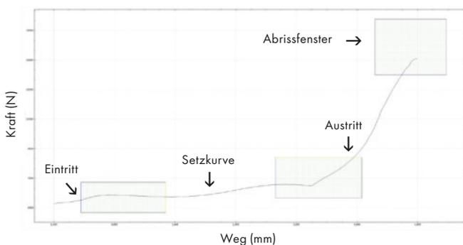
Grundlage für die WinTech-Setzprozessüberwachung ist der bewährte TAURUS® C. Dort wird der Setzprozess mit Hilfe von Weg- und Kraftsensoren über eine integrierte Elektronik ausgewertet. Mit einer speziellen Einricht-Software können bis zu drei Bewertungsfenster festgelegt werden. Am Gerät wird das Ergebnis der Setzprozess-Überwachung durch eine farbige Leuchtdiode dargestellt, via Datenleitung können die Werte auch aufgezeichnet und weiterverarbeitet werden.
