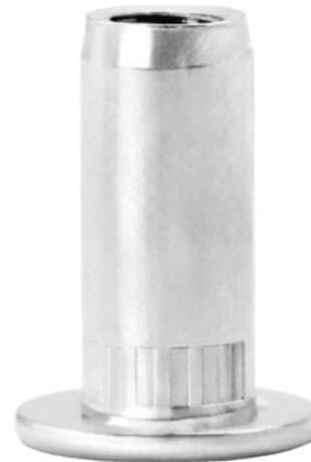
Die Montage belastet die Bauteile nur geringfügig. Der aufliegende Schließkopf mit sehr großem Durchmesser gewährleistet sehr gute mechanische Eigenschaften. Bauteilebeschädigungen werden vermieden. Durch die kontrollierte Ausbildung des Schließkopfes und die reduzierte Lochleibung können geringere Randabstände der Blindnietmutter bei größeren Lochtoleranzen realisiert werden. Die hochwertigen Materialien bieten hohe Korrosionsbeständigkeit des tragenden Gewindes.
